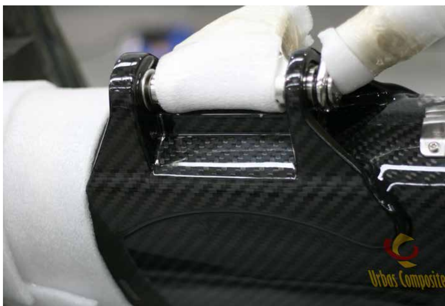
Rysunek 11: Zawias doklejony do masztu
