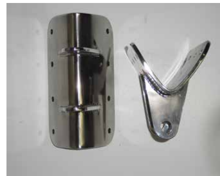
Rysunek 3. Stalowy zawias [5]
