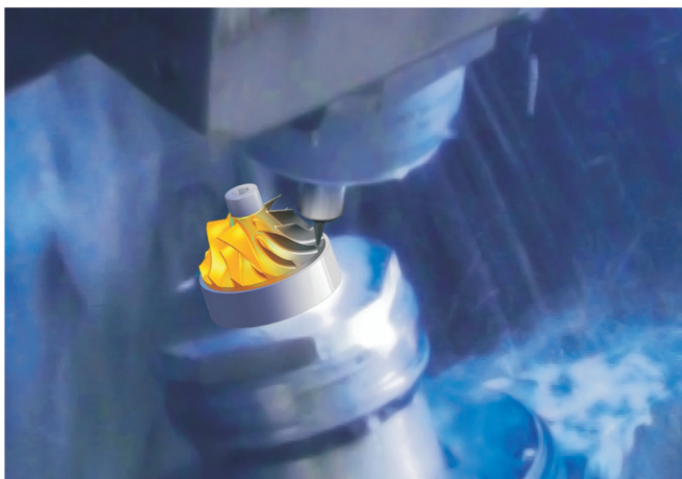
Rys. 2. Przykład obróbki zgrubnej 5-osiowej wirnika
